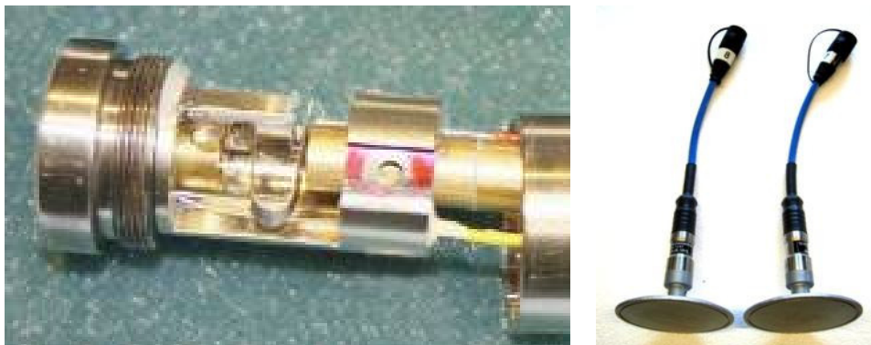
Figur 40 Från vänster: Sensorhuvud med interferometer; skyddsplatta med kontakter.
