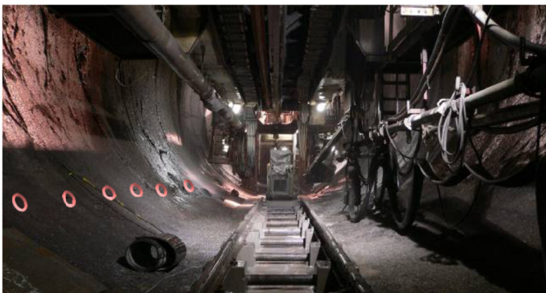
Figur 11 Exempel på uppställning vid seismisk undersökning i en tunnel, de seismiska skott-hålen är markerade med röda cirklar.
