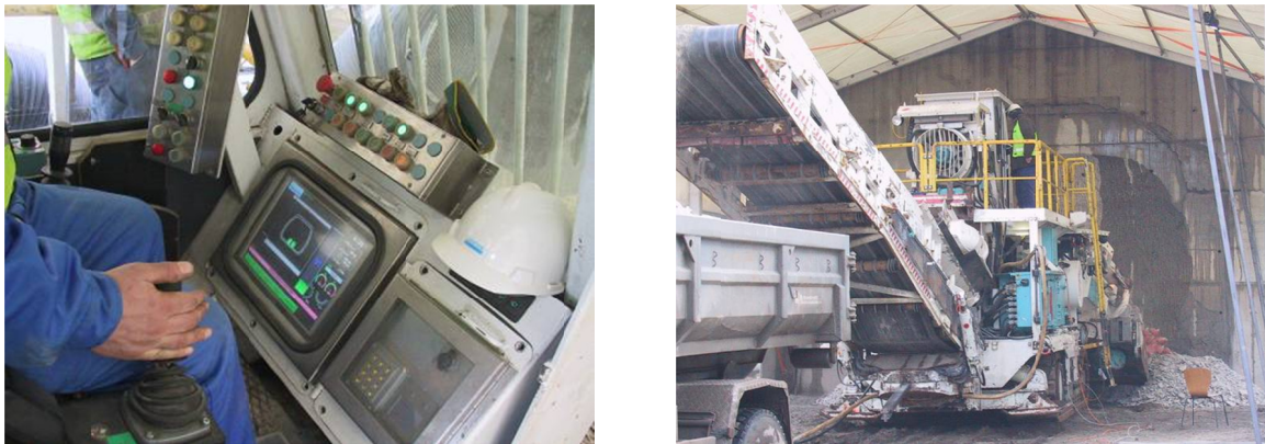
Figur 30 Mjukvara integrerad i SANDVIK roadheader ger maskinens position i tunneln direkt (vänster). SANDVIK roadheader (MT720/052) (höger).
