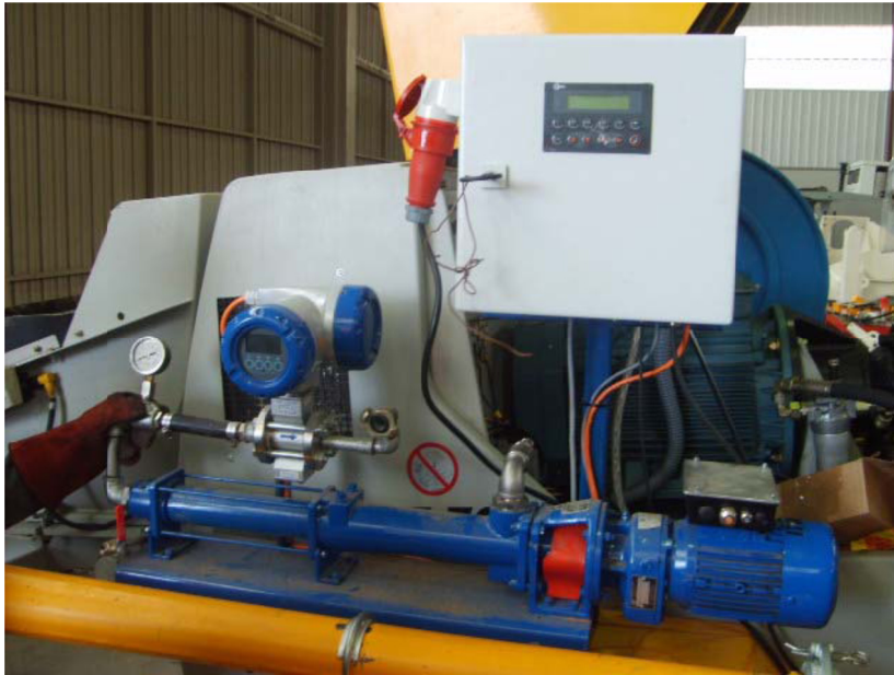
Figur 31 Prototyp av den nya doseringsenheten (AL 404.5) installerad på en SIKA-PM 407 sprutbetongsrobot
