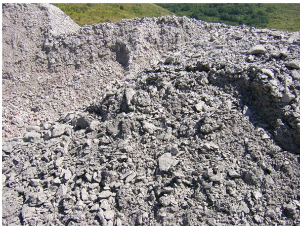
Figur 37 Schaktmaterial från Pajares-tunneln.
