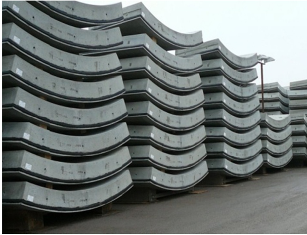
Figur 35 Betongsegment i nytvecklade material.
